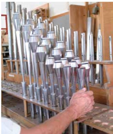
Der Zusammenbau der Orgel erfolgt zuerst als provisorische Vormontage in der Werkstatt, um zu prüfen, ob alles passt. Für den Transport wird die Orgel nochmals zerlegt und verpackt. Erst am Bestimmungsort wird das Instrument definitiv montiert. Hier erfolgt auch die Intonation und Stimmung der Orgel.
