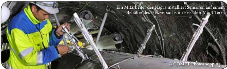
Ein Mitarbeiter der Nagra installiert Sensoren auf einem Behälter des Heizversuchs im Felslabor Mont Terri.
