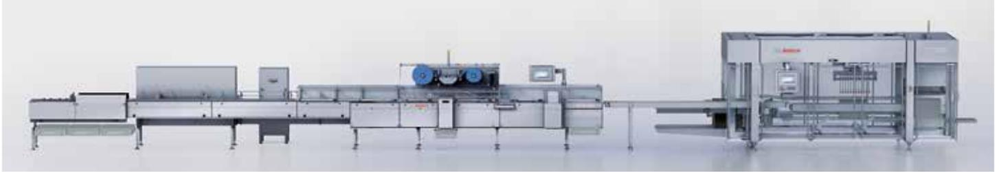
Das Two-in-One Biskuit Verpackungssystem kann bis zu 2'400 Biskuits pro Minute in Folie verpacken und im Anschluss direkt in Kartons stapeln.
