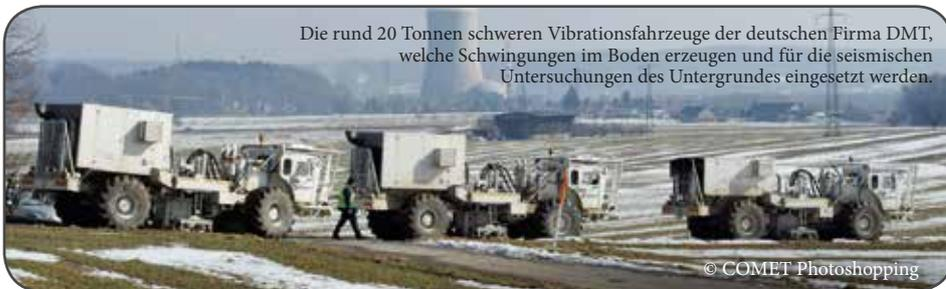
Die rund 20 Tonnen schweren Vibrationsfahrzeuge der deutschen Firma DMT, welche Schwingungen im Boden erzeugen und für die seismischen Untersuchungen des Untergrundes eingesetzt werden.
